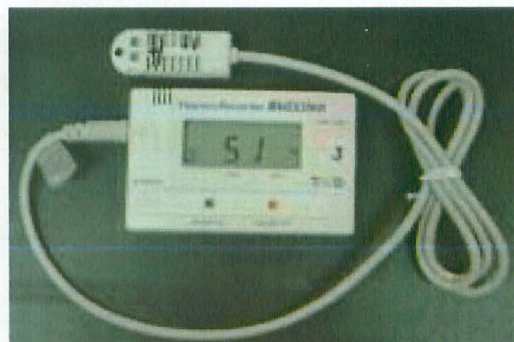
病室内温湿度計測用 Thermo Recorder
